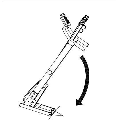
Поднимите беговую поверхность таким образом, чтобы отверстия на основании совместились с отверстиями на стойках. Вставьте в отверстия винты-барашки и зафиксируйте беговую поверхность в поднятом положении. Для того, чтобы разложить дорожку, проделайте описанные процедуры в обратном порядке.
