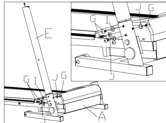
4. Вставьте правую стойку (E) в отверстие в основании (A). Следите за тем, чтобы не передавить провод! Закрепите стойку с помощью 4 коротких винтов (G), 2 плоских шайб (I) и 2 изогнутых шайб (J).
