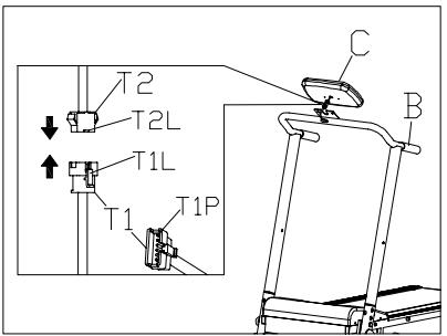
10. Закрепите компьютер на площадке с помощью винтов, удаленных на шаге 8.
