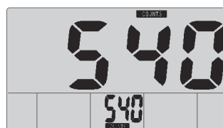
Рис. 9 Установка числа гребков (540 движений)
