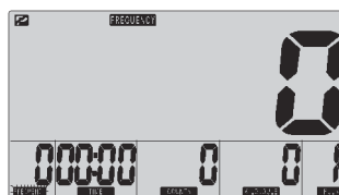
Рис.4 режим тренировки с установленными параметрами: значение символа "Frequency" (ритм) на экране мигает
