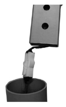
Соедините кабель, вставьте основание руля в раму, предварительно завинтив в него два винта, следите за тем, чтобы не пережать провод.
