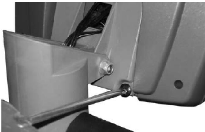
2. Отогните пульт и закрепите его на держателе, используя два винта и отвёртку.
