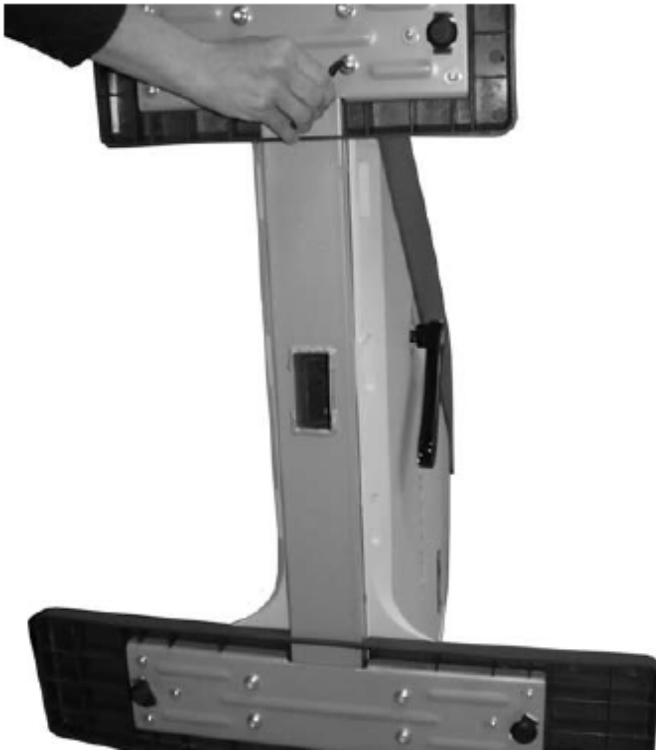
Наклоните тренажёр назад, так чтобы он стоял на корпусе и колёсах. Привинтите переднюю и заднюю опоры к раме четырьмя болтами с шайбами каждую.
