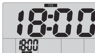
Рис. 8 Установка времени тренировки (18 мин)
